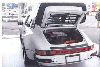
モーターはリアのエンジンルームに搭載。100kW・400Nmを発生し、最高速度は150km/h以上
