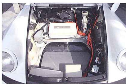
駆動用バッテリーは、水密性に優れるフロントの荷室に搭載。フロントがエンジンルームの車種の場合は漏電対策が必要
