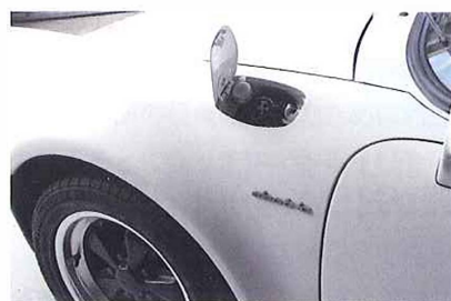
給油口の部分に充電インレットを取り付け、給電口になっている
