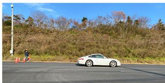
試験モード：時速 100 ㎞からのスパイク踏み制動～完全停止
